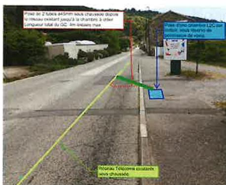
**La tranchée transversale sera implantée avec un angle de 70° par rapport à l'axe de la voie**
