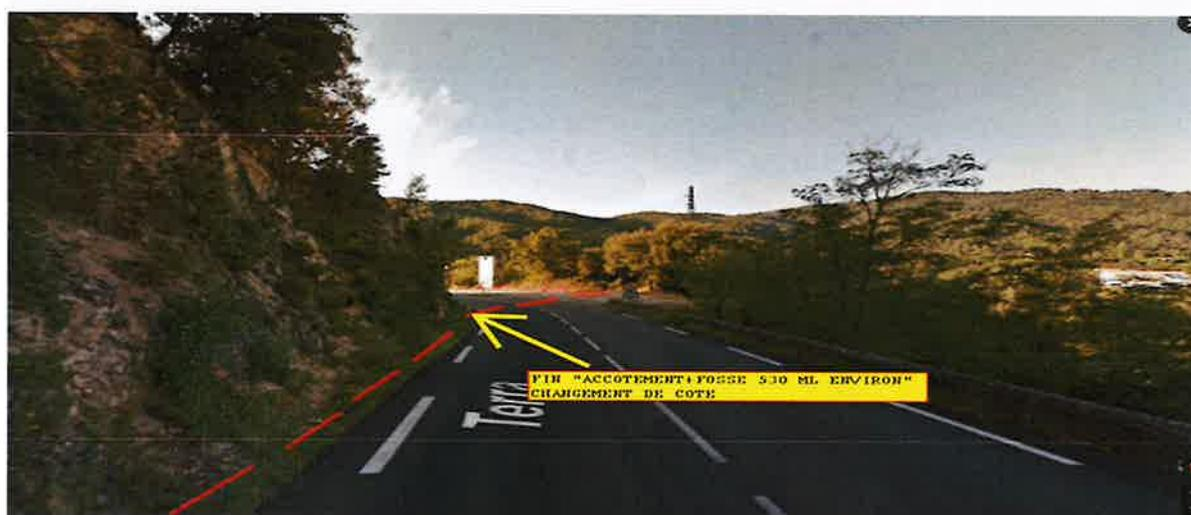
**3<sup>ème</sup> tranche :** Elle reprendra au droit du PR 5+310 où une traversée se fera en encorbellement dans l'ouvrage puis en terrain privé derrière les platanes puis dans le fossé bétonné jusqu'au PR 5+090 où une traversée sera réalisée en bais pour rejoindre de pied de l'accotement en face derrière les platanes jusqu'au PR 4+950.
